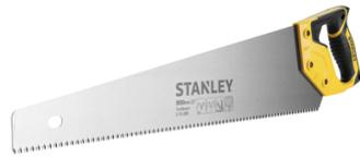
Scie égoïne jet cut hp 7 dents/pouce. Épaisseur de lame de 0.85 mm pour éviter le flambage de la lame. Traitement de denture HARDPOINT avec avoyage alterné : accroît la longévité de coupe, favorise une meilleure pénétration et facilite le sciage. Poignée ergonomique bimatière vissée en plastique antichoc et en élastomère souple pour une prise en main confortable et une plus grande sécurité Poignée permettant le traçage à 45° et 90°.
