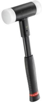
Manche en fibre de verre. Corps acier. Embouts spéciaux en nylon de dureté shore D74 ±5, aisément remplaçables. Poignée ergonomique pvc. Présentation : Epoxy noir. Embout de rechange : 212.E35 --> E60.
