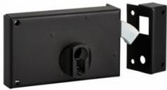
Serrure à pêne dormant crochet, destinée à un usage extérieur pour grille et de portail coulissant. Coffre en acier zingué finition époxy noir. Coffre et gâche en acier cambré. Contient un mécanisme de fermeture à 2 tours.
