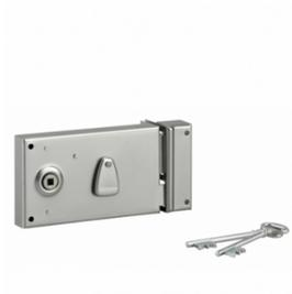
Coffre et gâche acier cambré. Pêne et demi-tour acier en saillie de 5 mm. Canon alliage longueur 40 mm. Entrée de clé laiton sur coffre. Mécanisme à 4 gorges laiton, 2 tours. Pêne 1/2 tour réversible pour porte ouvrant à l'extérieur. Carré 6 mm. 2 clés nickelées. 12 variures. Entrée de clé et de fouillot acier.
