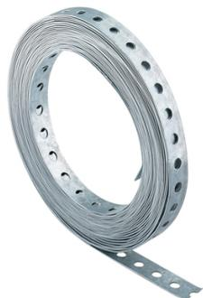
La bande perforée LBV de la marque Fischer est utile pour fixer facilement des tuyaux au sol. Elle peut être coupée à la longueur avec une cisaille et se conforme à tout diamètre de tuyau. Il existe deux versions de cette bande perforée : galvanisée et plastifiée, la version galvanisée est destinée aux installations intérieures.
