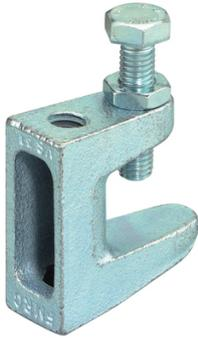
Pince à poutrelles fischer avec filetage pour une fixation simple par pinces sur les poutres métalliques. Des plaques de sécurité sont nécessaires pour les installations VdS à partir du DN 65. La forme de la vis évite efficacement le glissement de la pince sur la poutrelle.
