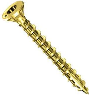
En acier zingué bichromaté. Evite le ripage de l'embout, permet des vissages dans des positions de travail délicates. 6 crans sous tête pour auto-fraisage et double cône pour meilleure résistance à la rupture.
