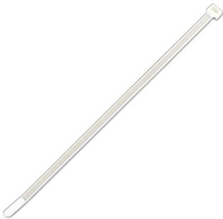
Le collier est muni d'une extrémité arrondie et d'un crantage sur les faces latérales pour une manipulation et une installation aisées. Résistance aux agents extérieurs : huiles, hydrocarbures, solvants chlorés. Résistance limitée aux acides. Non résistant aux phénols. Résistant à la flamme : UL 94V2.
