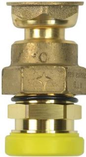
Raccords d'extrémités FLEXICLIC à joint plat compteur. Tuyau FLEXIPIPE annelé en acier inoxydable. Pression maximale d'utilisation du calibre 10 au calibre 25 : 2 bar. Pression maximale d'utilisation du calibre 32 au calibre 50 : 500 mbar.
