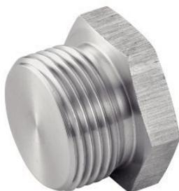
Raccord en inox ASTM A351 CF8M. Filetage conique BSP. Fabrication par procédé de ??cire perdue??. Température Mini : -25°C. Température Maxi : +180°C. Pression Maxi : 20 Bars.
