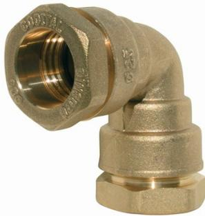
Raccord d'adaptation pour tube PE. Adduction, arrosage et irrigation. Raccord à serrage extérieur. Corps et écrou en laiton CW617N. Températures d'utilisation : -10 °C à +80 °C. Résiste à une pression maximum de 20 bar. Sécurité : joint torique en EPDM. Bague crantée conique en laiton. Résistance mécanique renforcée, anti-arrachement. Résistant à la corrosion.
