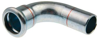
Courbe à 90° en acier au carbone avec une extrémité mâle et une extrémité femelle à sertir. Butée : bord d'arrêt pour extrémité de tuyau. Fourni avec toutes les homologations applicables. Fonction fuite avant sertissage. Identification claire lors du montage du matériau et de la dimension.
