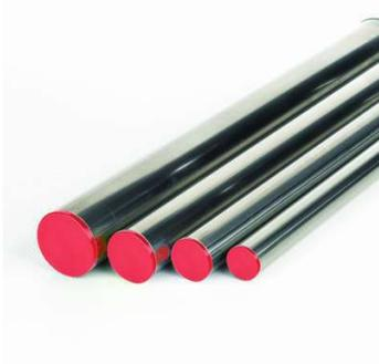
Tube de précision à paroi mince fabriqué conformément à la norme EN 10305-3 à partir d'un type spécial d'acier à très faible teneur en carbone. Le produit obtenu est très facile à cintrer. Les tubes sont également testés pour les fuites conformément à la norme ISO 10893-2:2011, de sorte que tous les tubes sont garantis sans fuite.
