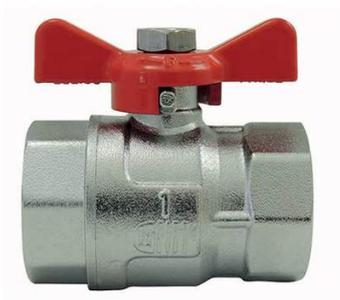
Laiton matricé, modèle lourd, passage intégral, PN40. Conception, fabrication et contrôle suivant la norme EN 13828. Filetage ISO 228-1. Revêtement 100% chromé (corps, sphère et axe). Etanchéité par double joint torique EPDM. Axe injectable. ACS
