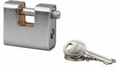
Corps acier monobloc. Cadenas muni d'un blindage acier cémenté et protection contre le perçage. Anse acier chromé. Mécanisme à goupilles. Le cadenas doit être fermé pour reprendre la clé. 3 clés acier nickelé.
