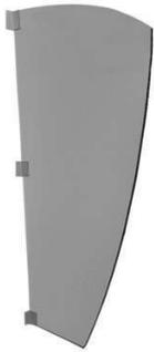
Séparateur d'urinoir équipé de 3 profilés rivetés sur le panneau pour fixation murale. Livré avec vis de sécurité et embout spécial pour l'installation. Matériau: Panneau CDF en fibre de bois haute densité - 3 profilés en aluminium anodisé - Dimensions : L 12 x P 385 x H 900 mm.
