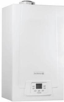
Chaudière murale gaz à condensation compact - Pu chauffage 28 KW- Pu ECS 33 KW - ECS par micro-accumulation débit spécifique 16L/min - Faible émissions Nox < 24 mg/kWh - Echangeur inox, brûleur gaz à prémélange total, modulant de 25-100%.
