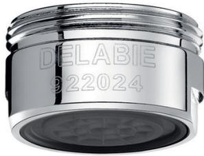
Sachet 2 pièces. Brise-jet antitartre pré réglé à 3 l/min (brevet DELABIE). Débit réglable de 1,5 à 6 l/min à 3 bar (selon le modèle de robinetterie) par l'extérieur avec une clé Allen 2,5 mm. Brise jet sans grille, limite le développement bactérien : pas de rétention d'eau ni dépôt d'impuretés. F22/100. Livré par 2 pièces. Garantie 10 ans. Les économies d'eau permises par le brise-jet ECO sont supérieures aux exigences de la classe "Z" de la norme NF EN 246.
