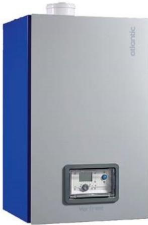
Corps tout inox. Brûleur à pré-mélange total modulant de 20 à 100 % (au gaz naturel). Faibles émissions polluantes (NOx classe 6). Gestionnaire de chaudière intégré. Fonctionnement au propane jusqu'à 100 kW.
