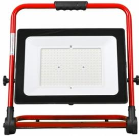
3m de câble H05RNF 3G1, très grande luminosité, économie d'énergie. Led de type SM avec grande durée de vie : 40 000 H. Faible dégagement de chaleur. Tête en IP65 et fiche IP44. Vitre : non démontable. Possibilité de l'adapter sur un pied télescopique.
