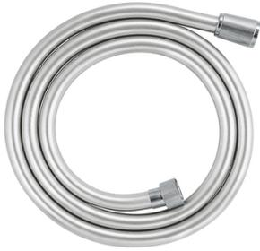
1750 mm; Surface lisse pour un nettoyage facile. Résistance aux torsions jusqu'à 500N. Résistance à la pression jusqu'à 5 bars. Résistance à la chaleur 70°C. Anti-pliers résistant aux pliers. Connexion universelle G 1/2" x 1/2". Système anti-torsion Twistfree
