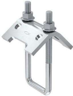
Conception permettant la fixation sans perçage ou soudure. Longueurs différentes des côtés de la griffe permettant la fixation sur toutes les poutrelles en T standards. Forme de la griffe à poutrelle garantissant le repositionnement simple du rail. Utilisée pour fixer des profilés sur poutrelles métalliques. Matière plaque support / étrier : Acier S235 JR (Matière n° 10037) selon DIN EN 10025. Matière écrou : Acier classe de résistance 8. Traitement : Acier électrozingué, env. 5 m.
