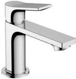
Mitigeur de lavabo, garniture de vidage. ComfortZone 80. Projection : 121 mm. Hauteur du bec : 84 mm. Jet normal. Débit maximal à 3 bars : 5 l/min. Cartouche céramique bas débit. Limiteur de température réglable. Convient au chauffe-eau instantané. Garniture de vidage 1"1/4. Matériau de la garniture de vidage : synthétique. E00, CH3, A3, U3. CoolStart : démarrage en eau froide en position de poignée centrée.
