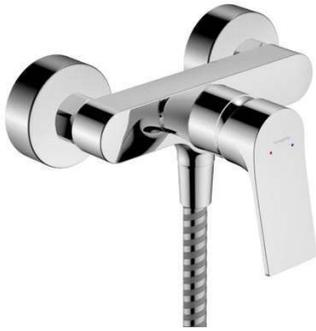
1 fonction. Distance du centre: 150 mm  $\pm$  12 mm. Débit maximal à 3 bars : 14,9 l/min. Débit de la douchette à 3 bars : 14,9 l/min. Cartouche céramique. Limiteur de température réglable. Clapet anti-retour. Avec silencieux. Type de raccordement : raccords S.
