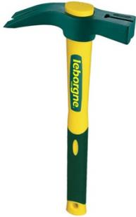
Griffes et angles de la surface de frappe arrondis. Manche ergonomique tri-matière Novamax® haute résistance avec pare-faux-coup acier. Emmanchement douille rase. Acier au Carbone forgé, trempé et revenu. Aimant porte-clou pour pointer d'une main sans tenir le clou. Surfaces de frappe latérales pour travailler dans les espaces réduit.
