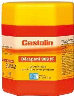
Le décapant en pâte constitue d'un mélange de sels complexes de potassium, borates et fluoroborates pour métaux cuivreux. Il est destiné au brasage capillaire à l'aide des alliages cupro-phosphore. Brasage des tuyauteries gaz en cuivre avec la baguette Castolin 808 G. Certifié ATG n°1521.
