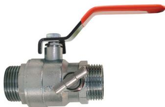
Passage intégral. Corps, sphère et manchon en laiton matricé OT58 chromé. Température maximum 120 °C. PN 32. Sièges PTFE - O-ring EPDM. Poignée et écrou en acier chromé. Etanchéité par technologie double joint o-ring. Axe chromé boulonné. Filetage ISO228. ACS. Agrément et marquage "CE". Numéro de lot et date de fabrication sur le corps.
