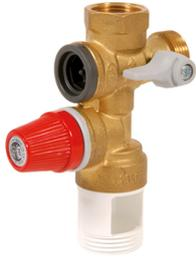
Protège les chauffe-eau jusqu'à une puissance de 10 kW. Corps, vanne à sphère et clapet anti-retour en laiton, sans chrome. Pression de tarage de la soupape de sécurité: 7 bar. Agréé NF. Pose d'un entonnoir siphon obligatoire.
