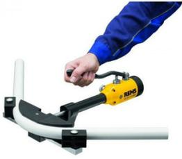
Cintreuse arbalète Hydro-Swing pour tube cuivre et multi-couche. Cintrage précis de tubes jusqu'à 90°. Tubes cuivre recuit Ø 10 - 22 mm / Ø 3/8" à 7/8". Tubes inox à sertir Ø 14 - 22 mm, s ? 1,2 mm. Tubes multicouche Ø 14 - 32 mm.
