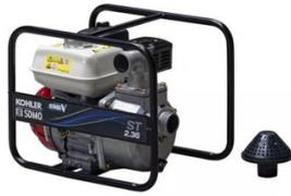
Type liquide Pompage d'eaux claires ou peu chargées. Diamètre d'aspiration 50 mm. Diamètre de refoulement : 50 mm. Débit maximum : 600 L/min. Débit maximum : 36 m<sup>3</sup>/h. Hauteur d'élévation : 29 m. Hauteur d'aspiration : 8 m. Granulométrie : 8 mm. Amorçage automatique. Essence. Conso. 75% : 1 L/h. Autonomie 75% : 2 h. Moteur HONDA. Cylindrée : 118 cm<sup>3</sup>. Capacité huile : 0,60 L.
