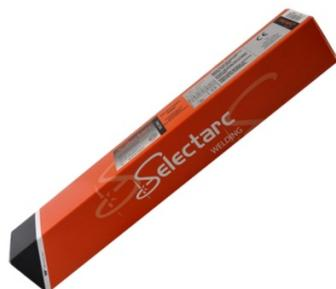
Electrode rutile universelle. Applications très variées en toutes positions, fusion agréable et laitier d'enlèvement facile. Convient parfaitement dans le cas d'utilisation d'appareils de soudure avec de très basse tension à vide. Principales applications : Constructions métalliques, réservoirs, tuyauteries, travaux artisanaux, serrureries.
