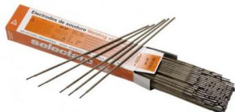
Electrode rutile universelle. Applications très variées en toutes positions y compris verticale descendante. Amorçage facile, très faible tension d'amorçage, laitier auto détachable, arc vif sans projection, très bonne pénétration, peu sensible à la propreté et aux pièces mal préparées (peinture, graisse, rouille). Hautes caractéristiques mécaniques. Principales applications : Chaudronneries, tôleries, serrureries, charpentes, travaux publics, matériels agricoles, travaux de maintenance?..
