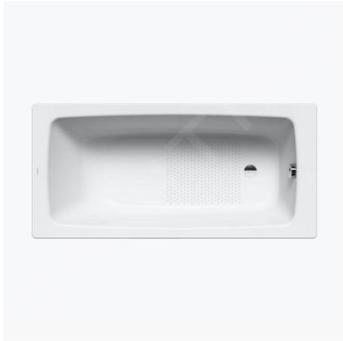
Modèle : 748. Baignoire en acier émaillé avec traitement de surface antidérapant Antislip. Fabriqué de en acier de qualité 2,9 mm + / - 0,14 mm. Evacuation et trop-plein dans la zone du pied. Forme extérieure rectangulaire. Monoplace. Pieds de baignoire et siphon non inclus. Résiste aux rayures, à l'abrasion, aux acides et produits chimiques.
