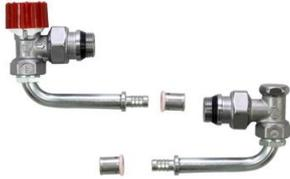
Kit prémonté composé : 1 robinet équerre 15x21 M30x1,5 mm. 1 coude de réglage 15x21. 2 coudes chromés orientable à 360°. 2 raccords à sertir par écrasement ou glissement selon modèle. Douille auto-étanche.
