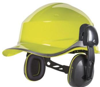
Coquilles antibruit pour casque de chantier réglables en hauteur. Bras et coquilles ABS haute flexibilité. Coquilles rembourrées en mousse synthétique. A utiliser directement sur le casque ou avec le porte-visière VISOR HOLDER. Adaptable sur casques GRANITE, SUPER QUARTZ, QUARTZ, ZIRCON et BASEBALL DIAMOND.
