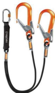
Absorbeur d'énergie avec longe drisse double (Y) intégrée. Un connecteur amovible est positionné côté absorbeur d'énergie et deux connecteurs amovibles ou inamovibles côté longe pour travaux en hauteur sur plan vertical ou horizontal avec risques de chute verticale par dessus une arête vive (Rayon : 0,5 mm) et avec espace disponible sous les pieds de l'utilisateur (voir tirant d'air).
