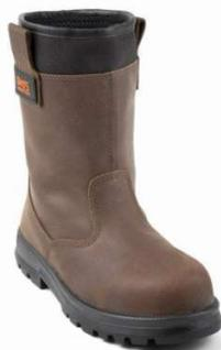
Bottes de sécurité SUTRA non fourrées en cuir hydrofuge et oléofuge et embout 200J en composition isolant du froid et de la chaleur. Semelles en polyuréthane double densité, anti-perforation acier 1100 N avec un décroché du talon de 14 mm. Avantages : Chaussant large, anses de préhension, semelle très crantée conçue pour une grande stabilité sur sols accidentés. Destinées principalement au métier du BTP et l'industrie lourde. Normes : EN ISO 20345 | S3 | CI | SRC
