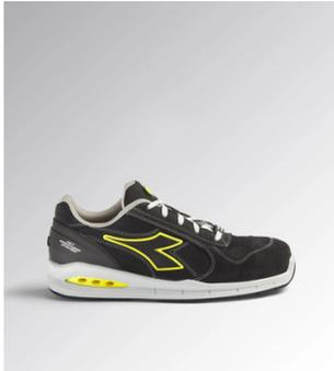
Chaussures de sécurité basses S3 en croûte de cuir velours déperlant, avec système de respiration latérale Net Breathing System by Geox. Bout en aluminium 200J. Chaussant 11. K SOLE, doublure en nylon anti-abrasion et ultra-respirant, semelle de propreté amovible et respirante, traitée aux charbons actifs.
