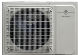
CLIM'UP MUSE est une gamme de climatiseurs air/air pour la climatisation et le chauffage par air soufflé. Elle peut être associée à une ou plusieurs unités intérieures UME../UCE../UGE../UCARE. Pompe à chaleur air/air réversible, elle est équipée de la technologie full DC inverter, d'un compresseur Rotary DC Inverter, d'une vanne 4 voies pour l'inversion des modes chaud/froid, d'un ventilateur modulant, de fluide frigorigène R32.
