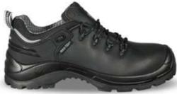
Chaussure de sécurité basse avec semelle extérieure résistante à la chaleur. Tige en cuir, doublure en membrane et embout en composite. Semelles intérieures en mousse SJ, semelles extérieures en PU/caoutchouc et semelles anti-perforation. Normes : ASTM F2413:2018 | EN ISO 20345:2011 | S3 | ESD | CI | HRO | SRC | WR
