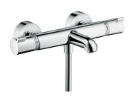
Thermostatique bain/douche G 1/2. Inverseur intégré dans la poignée. Verrouillage de sécurité à 40°. Limitation d'eau chaude préréglable. Clapets antiretour. Raccords S avec amortisseur de bruit. Entraxe 150 +- 12 mm.
