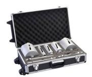
Couronnes de forage à sec diamantée G 1/2". Diamètres : 38 - 52 - 65 - 117 - 127 mm. Longueur de travail : 150 mm. Nombre de segments : 4. Hauteur de segment : 7 mm.
