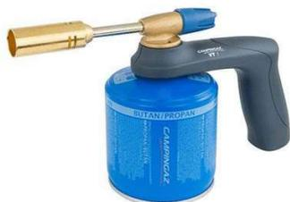
Système Easy Clic Plus permettant le raccordement de la lampe à souder à la cartouche en 1/4 de tour. Flamme réglable à une température de 1750 °C. Equipée d'un brûleur en laiton X1400. Brûleur interchangeable avec d'autres accessoires (vendus séparément). Poignée en polypropylène. Autonomie allant jusqu'à 3h 30 (avec cartouche CV470+).
