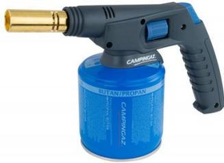
Lampe à souder multi-usage équipée d'un brûleur en laiton X1700 hautes performances. Brûleur interchangeable avec d'autres accessoires (vendus séparément). Poignée ergonomique en polypropylène. Lampe à souder dotée du système EasyClic Plus permettant le raccordement de la lampe à souder à la cartouche en 1/4 de tour. Débit de la flamme réglable en une seule main jusqu'à une température de 1750 °C. Utilisation simplifiée grâce au système d'allumage manuel Piezo.
