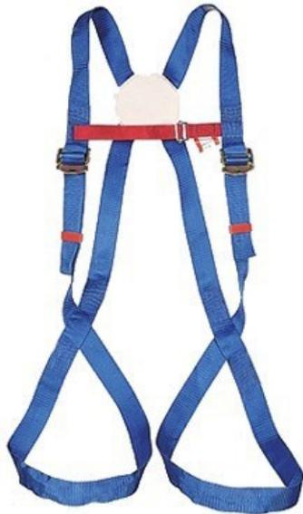
Harnais : Harnais en sangle polyester de conception simple. Seul un réglage des cuisses par boucles automatiques Rapco est possible. Avec 2 points d'accrochage : dorsal et sternal par la liaison des 2 papillons en sangle. 1 Point DORSAL permet de connecter un système d'arrêt des chutes dans le dos. Longe polyamide : Longe en cordage polyamide toronné D.12 mm de 1.50 mètre. Avec 2 épissures et 2 mousquetons.
