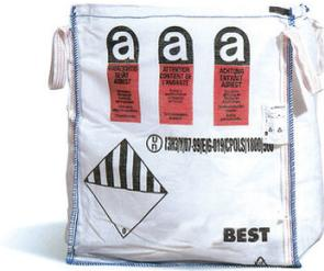
Sac Milieu Bag en toile polypropylène 140 g/m<sup>2</sup> avec doublure polyéthylène, destiné au déflocage de l'amiante. Pour le conditionnement des protections individuelles souillées et le flocage. Jupe de fermeture, 4 sangles de levage. Marquage réglementaire sur 2 faces. Capacité : 1 m<sup>3</sup>/1000 kg. Norme : ONU 13H3 groupe 2 pour le transport des matières dangereuses.
