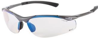
Nez anti-glisse. Branches TIPGRIP anti-glisse. Anti-statique. Impact à faible énergie 45 m/s : résistance aux chocs d'une bille d'acier de diamètre 6mm et de minimum 0.86g lancée à 45m/s. Adaptée pour le risque mécanique - impact à températures extrêmes (autorise l'utilisation pour les particules lancées à grande vitesse à température extrême). Traitement ESP pour réduire l'éblouissement et les agressions de la lumière bleue.
