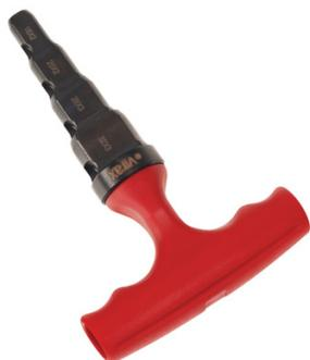
16x2 / 20x2 / 25x2,5 / 26x3 / 32x3. Double fonction : calibrage et ébavurage intérieur. 4 diamètres pour calibrer les dimensions les plus utilisées. Produit résistant, corps en acier bruni, dureté 95 HrB.
