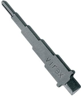
Destinée au montage des raccords à écrou prisonnier qui assurent la liaison entre le radiateur et son robinet de réglage. Carré d'entraînement de 18 mm. Outil en acier forgé.
