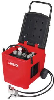
Economique à l'usage : pas d'utilisation de bouteille de gaz. Facilement transportable : grâce à son arceau pliable et ses roues. Temps de congélation très court : pour diminuer les temps d'intervention. Simple d'utilisation grâce au thermomètre intégré à ses pinces frigorigènes.
